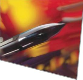
Loop). Sein „Multi-Mode“-Suchkopf erlaubt passive und aktive 3D-Bildgebung, ist robust bei allen Wetterbedingungen und intensiven elektronischen Gegenmaßnahmen.
