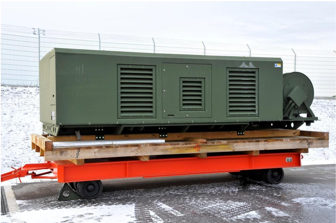
*Die auf Palette montierte Schnittstelle zum kommerziellen Netz ermöglicht die Versorgung beider Radare mit kommerziellem Strom.*
