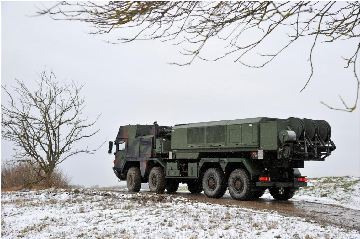
*Die MEADS-Stromversorgungs- und Kommunikationseinheit liefert Energie für beide MEADS-Radare und umfasst einen auf dem nationalen Prime Mover montierten Generator.*
